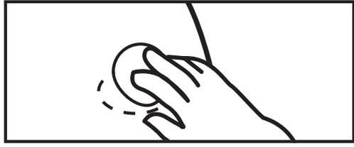
Espera a que el adhesivo adquiera un aspecto viscoso y pegue el parche en el área alrededor de la fuga. Puede ejercer una ligera presión (por ejemplo, con una cuchara) para que la unión quede más compacta.
