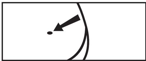
En el caso de que su tabla de paddle surf tenga una fuga, localícela y limpie el área circundante a esta en unos 6 centímetros de diámetro. Corte una pieza de reparación de la misma medida (6cm) de la tela de parche que se incluye en el kit de reparación de pinchazos.
